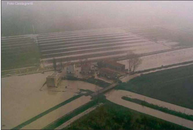
Foto 6 - Colorno (PR), ottobre 2000. Esondazione del Canale Naviglio, a causa del rigurgito del T. Parma. L'immagine documenta l'allagamento di terreni agricoli in corrispondenza di un impianto di manovra del Consorzio di Bonifica (foto scattata da Stefano Castagnetti).
