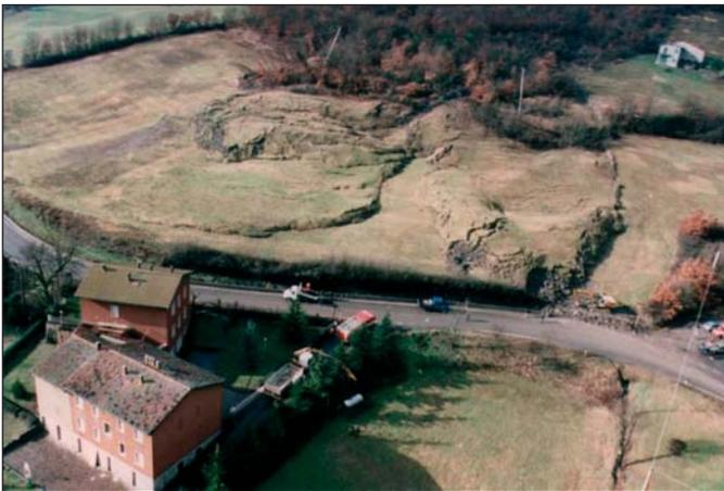
Foto 1 - Frana di Marano (Comune di Gaggio Montano, Bologna). La frana non ha ancora raggiunto la strada SS 64 Porrettana ed i fabbricati a valle (foto Pelagalli per conto del Comune di Gaggio Montano).
